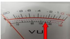
Überprüfen Sie das Amperemeter an der Vorderseite und vergewissern Sie sich, dass die Nadel sich im Bereich von  $I_A = 120 \text{ mA}$  befindet, wie in der Abbildung links dargestellt. Diesen eingestellten Wert einmal in der Woche überprüfen u. korrigieren.
