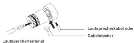
Vergewissern Sie sich, dass nicht unisolierte Kabel die Lautsprecherausgänge kurzschließen oder die Ausgangsstufe des Verstärkers beschädigen können.
