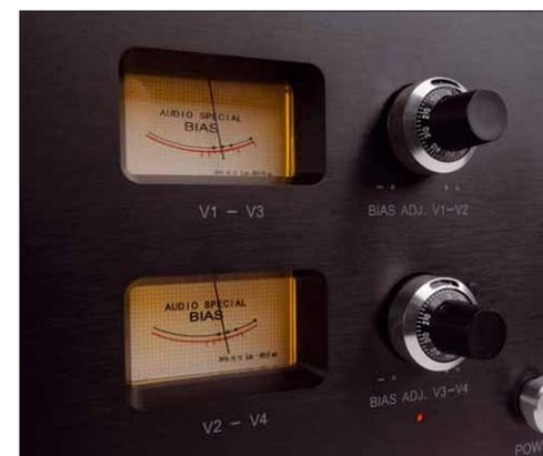
*Gleich zwei Messgeräte dienen dem Abgleich der Ruheströme der Röhren*
