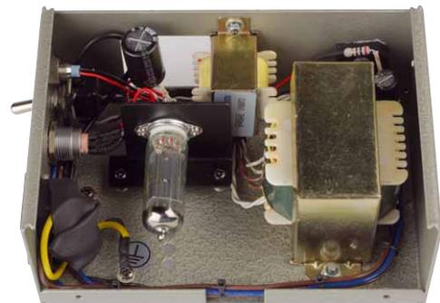
Das Netzteil verwöhnt mit Röhrengleichrichtung und Drosselsiebung
