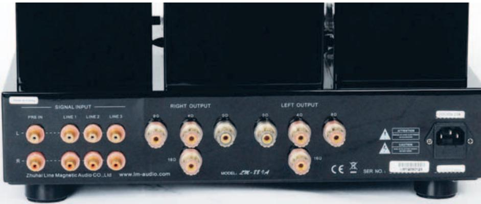
Line Magnetic bietet drei unterschiedliche Klemmen für die Lautsprecherkabel an – vier, acht oder 16 Ohm. Dazu gibt es drei Cinch-Eingänge und einen Pre-In. Intern wird alles Punkt-zu-Punkt verdrahtet.
